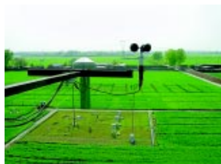
栾城站(5)的小气候观测装置(胡春胜摄)
