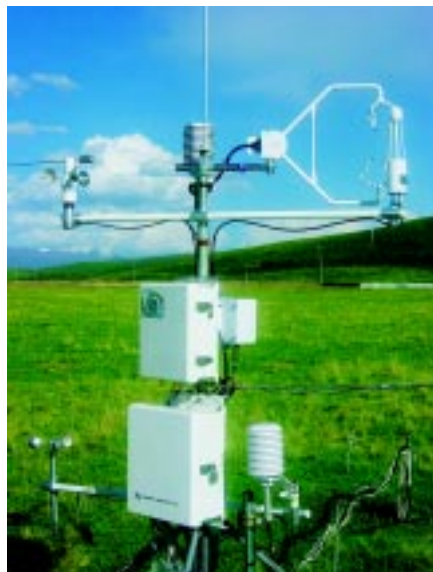
海北站(25)的涡度相关观测装置(赵新全摄)
